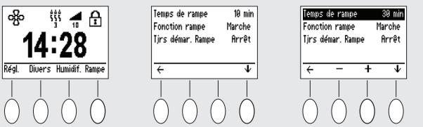
Utilisez les 4 boutons situés sur l'écran pour naviguer dans le menu. Vous pouvez modifier les réglages de l'appareil, ceux de l'alarme de réveil, de l'humidificateur et de la rampe et consulter les paramètres du traitement. En fonction de votre position dans le menu, les boutons offriront différentes fonctions. Voici les icônes utilisées :
