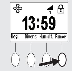
Pour activer/désactiver l'humidificateur pendant le fonctionnement de la iSleep : Appuyez sur la touche programmable Humidification jusqu'à ce que le symbole Humidification apparaisse/disparaisse.
